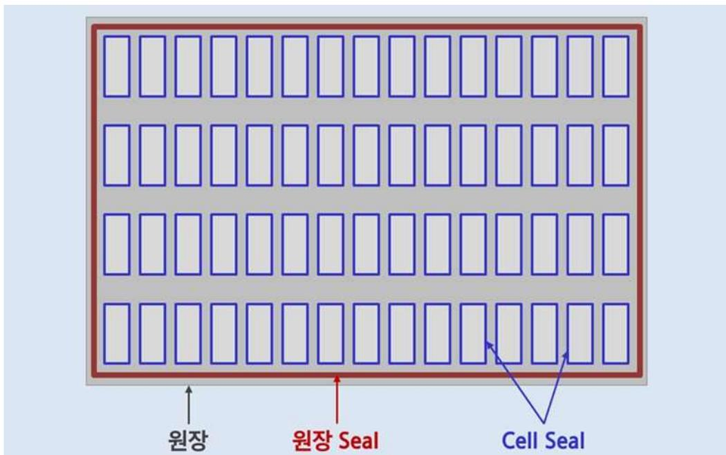
[그림 1-32] 원장 Glass Seal 도포
