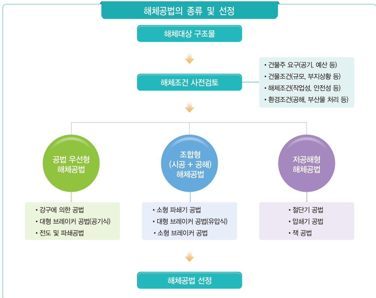
건축물의 해체공사는 공기 및 예산, 구조물 현황, 해체조건, 공해 및 부산물 처리의 환경조건 등을 종합적인 조사 및 검토를 통해 결정된다. 해체공법은 해체 효율 및 경제성을 중시한 공법 우선형 해체공법과 시공성과 공해방지를 적절히 고려한 조합형 해체공법, 소음, 진동 등의 환경조건에 중점을 둔 저공해형 해체공법으로 구분하였으며, 각 해체 공법별 종류 및 특징은 다음과 같다.
