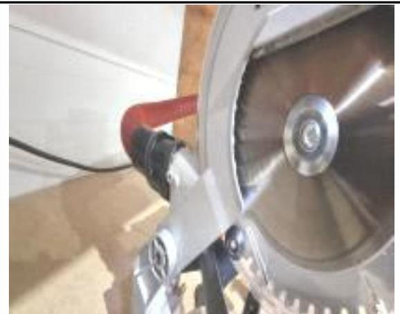
절단기 덮개 사용 및 분진 발생 방지 목적으로 집진기 직결 설치
