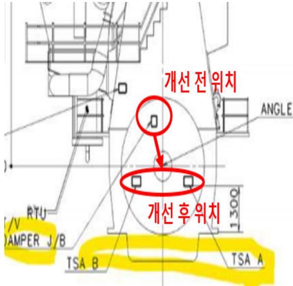
고소작업용 작업발판 설치 없이 육안확인 가능한 위치로 Monitor JB 위치 변경
