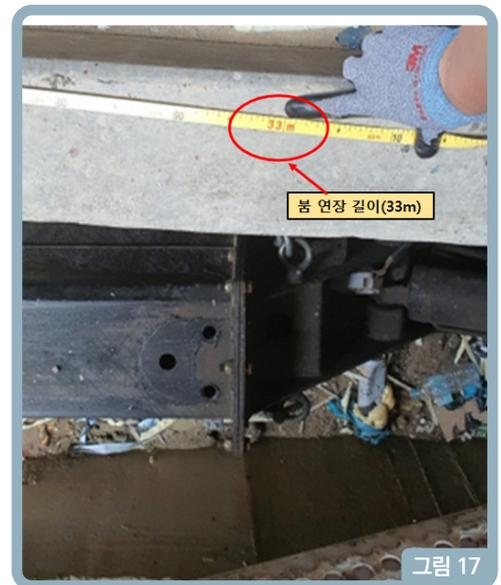
[그림 17] 붐(boom) 연장길이 측정
