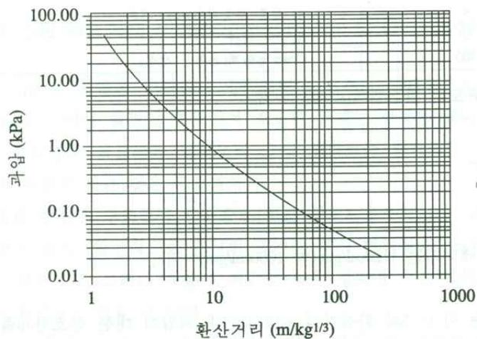
[그림 6] Scale Rule에 환산거리 및 과압 관계표
