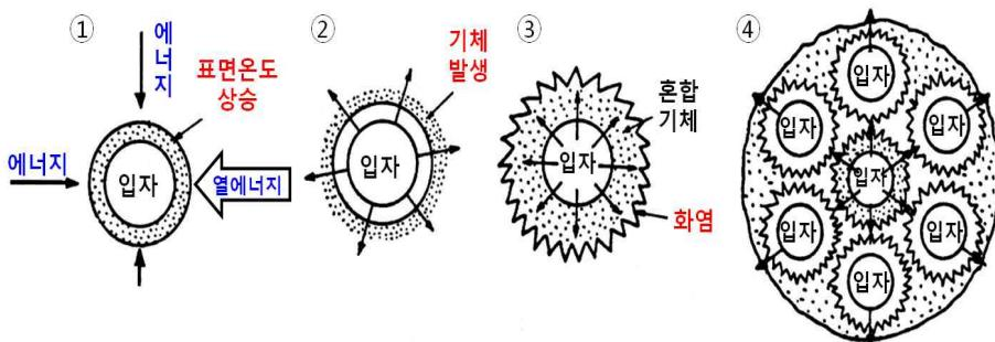
[그림 7] 분진폭발의 연쇄적 Mechanism
