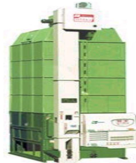
이 곡물의 반출을 위한 스크루컨베이어(screw conveyer), 버킷엘리베이터(bucket elevator)와 곡물을 균일하게 건조시키기 위하여 상하층간의 곡물을 서로 섞어주는 곡물환원장치(grain recirculator) 및 곡물을 균일하게 투입하기 위한 곡물 균분기(grain distributor)가 장치되어 있는 것도 있다.
