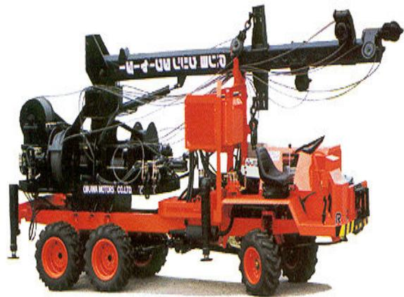
용도는 일반 집재기와 비슷하나 이동, 설치가 쉽게 자체에 타워가 부착되어 임도상에 설치하여 대형의 경우 800m까지 집재를 할 수 있으며, 일반 집재기가 1회 가선 통로를 설치하는데 2~3일 소요되는데 비하여 설치조건이 좋으면 몇 시간 내로 설치 작업을 신속히 할 수 있으므로 점차 일반 집재기를 대체하는 추세이다. 스카이라인 설치가능 길이에 따라 소, 중, 대형으로 분류하며, 트랙터에 부착하여 300m까지의 상향 집재만이 가능한 기종부터 전용차량에 탑재되어 800m 까지 상하향 집재가 가능한 기종 등의 대형기종까지 있다.
