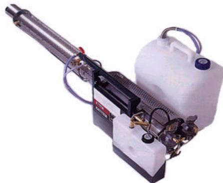
**11.1 고온 煙霧機** 위생용이나 시설원예용으로 널리 사용되는 방제기로서 연료와 공기의 혼합가스를 연소실에서 폭발시킬 때 발생하는 펄스제트(pulse jet)를 이용한다. 즉, 배기가스가 공랭되어 70-80℃ 이하로 되었을 때 약액을 배기관으로 분사하여 연무를 만든다. 주요 구성요소는 연료탱크와 연소부, 약액조절 및 분사계통, 전원부로 구성된다. 전원은 교류전기를 사용하거나 축전지를 이용하며 점화플러그의 작동과 공기 펌프의 구동에 사용된다. 흡입된 공기는 펌프에 의하여 가압되어 일부는 연료와 함께 가압되어 일부는 연료와 함께 분사되고 일부는 약액통을 가압하여 약액을 배출시킨다.
