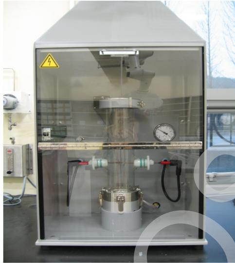
[그림 10] Modified Hartmann Apparatus
