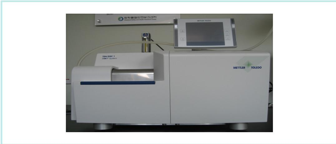
[그림 7] 열중량분석(TGA) 장치
