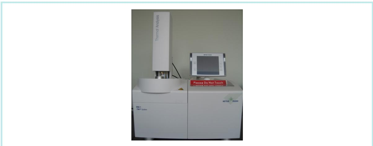
[그림 9] 시차주사열량분석(DSC) 장치
