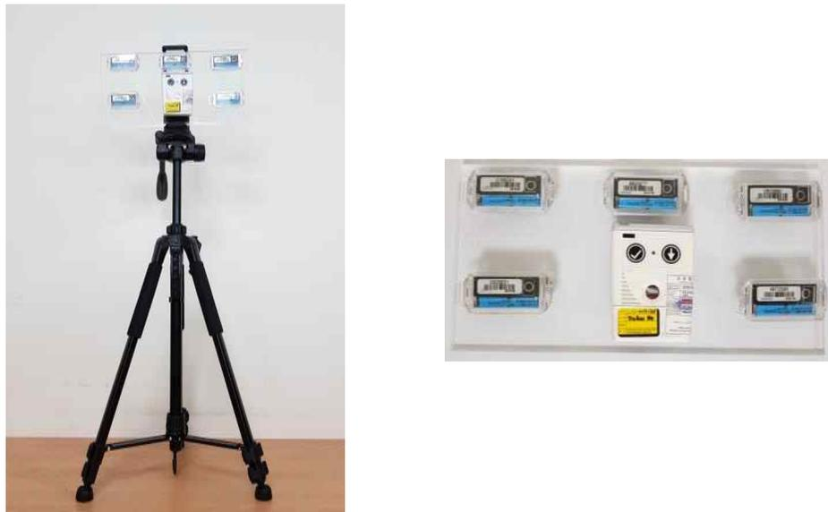
[그림 II-8] 피폭선량 측정을 위한 선량계 배치
