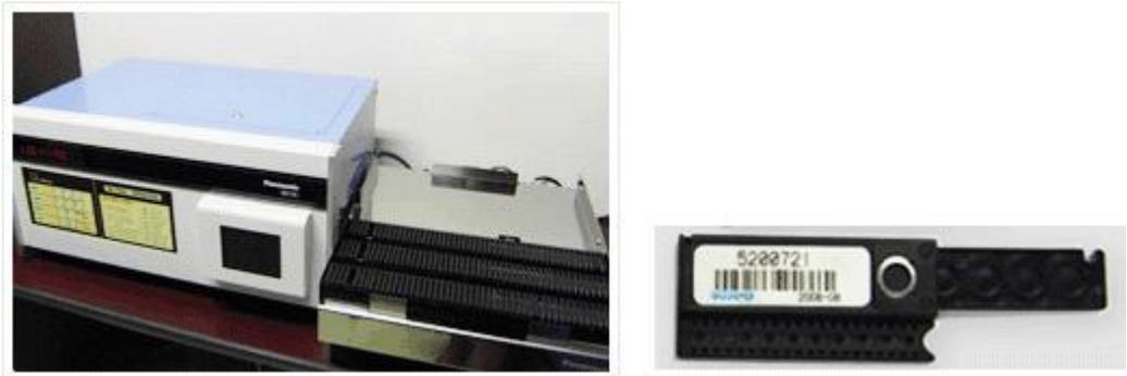
[그림 II-6] TLD 판독시스템 및 선량계 소자
