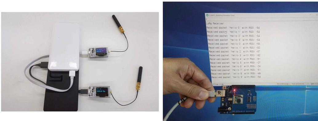
[그림 38] LoRa 통신모듈 테스트
