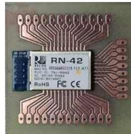
**[그림 40] Outsourcing PCB Circuit Design과 CNC PCB Fabrication 과정**
