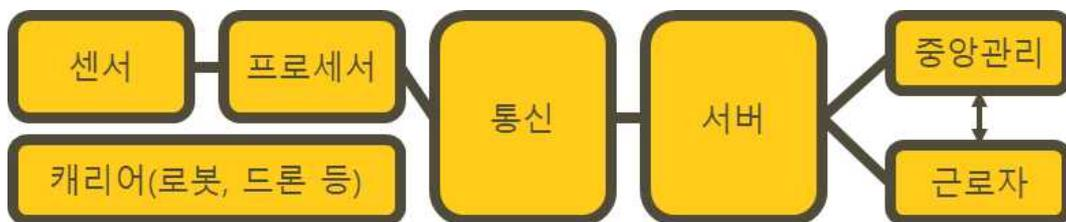
[그림 1] IoT 밀폐공간 측정 시스템 개념도.
