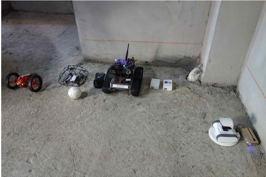
**[그림 54] 건설현장평가에 사용된 캐리어 및 측정기기**
