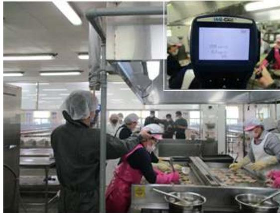
[그림 III-7] CO, CO<sub>2</sub> 농도 분포 측정 모습
