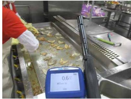
(b) CO, CO<sub>2</sub> 농도 측정 모습
