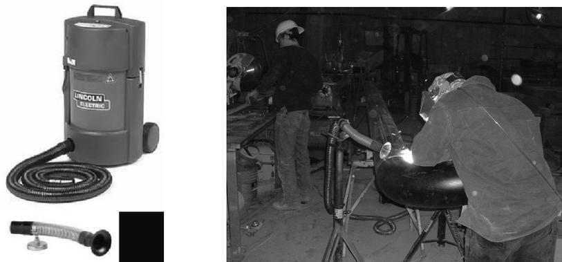
[그림 21] 용접흡 배기용 집진기 및 현장 사용 모습
