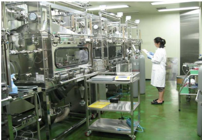
[사진 1] 흡입챔버를 이용한 시험물질 노출시험 전경
