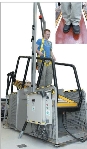
HSL 램프 테스트. 테스트 참가자가 미끄러질 때까지 바닥 표면이 기울어진다.
