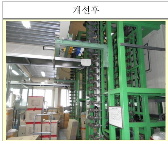
[그림 III-30] 장갑 자동배출 장치
