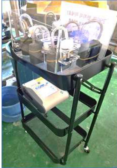
[그림 II-1] 시료채취 카트의 구성
