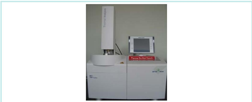
[그림 3-2] DSC(Differential Scanning Calorimeter)
