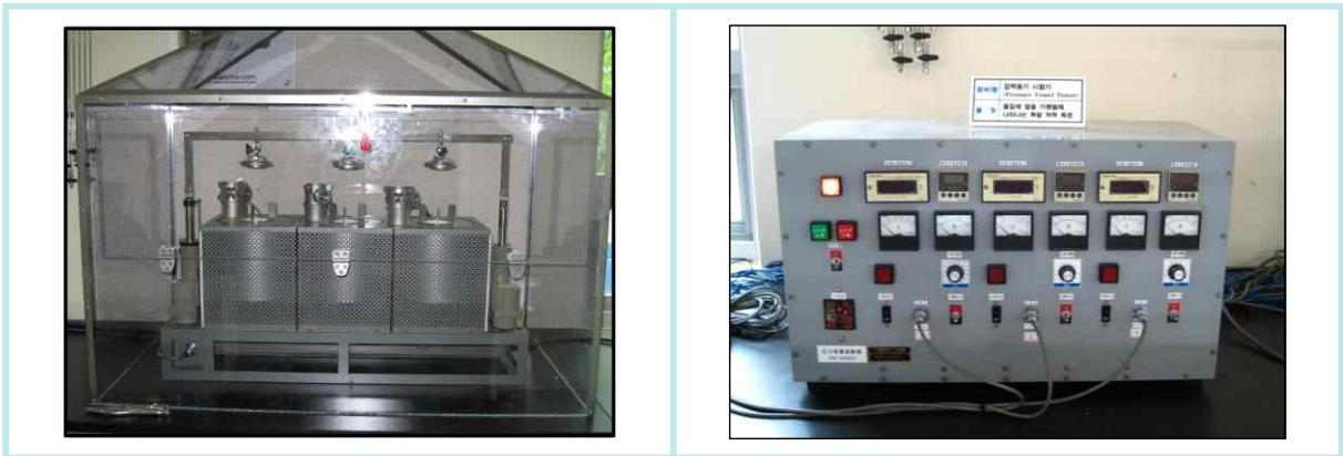
[그림 13] 미국식 압력용기 시험 장치
