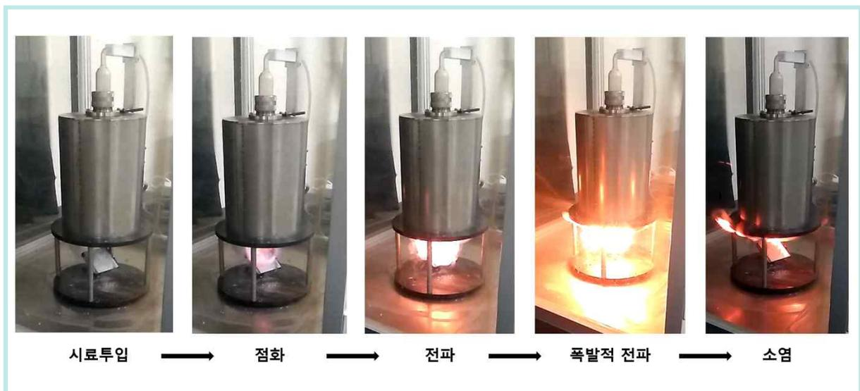
[그림 42] G-G furnace를 이용한 TBM의 MIT평가
