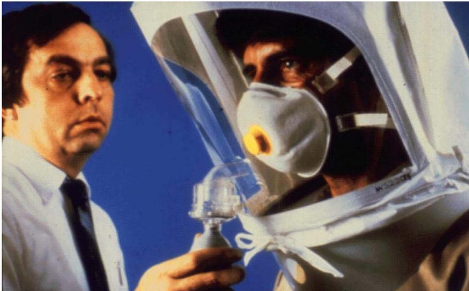
호흡보호구는 사용 후 수명이 있으므로, 적절한 주기로 새 제품으로 교체해 주어야 한다. 방진마스크의 경우는 호흡 저항이 커지면 필터를 교체해 주고, 방독마스크의 경우는 냄새, 맛, 자극이 느껴지면 새 정화통으로 교체해 주거나 수명예측 software 를 사용하여 교체주기를 설정한다.
