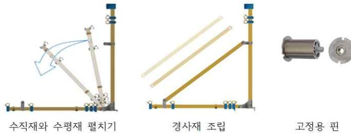
[그림 V-61] 시스템 비계 설치·해체 매뉴얼
