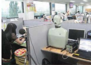
(사진) HATS를 사용한 측정 모습
