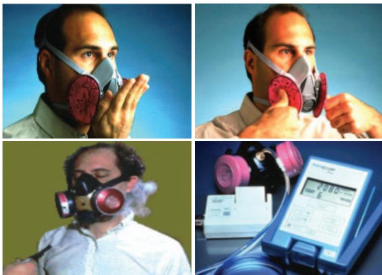
호흡보호구의 기밀 테스트(상)와 Fit 테스트(하). 기밀 테스트는 숨을 내쉴 때 하는 양압검사(좌상)와 숨을 들이마실 때 하는 음압검사(우상)가 있고, Fit 테스트는 정성검사(좌하)와 정량검사(우하)가 있음 ([www.osha.gov](http://www.osha.gov)).
