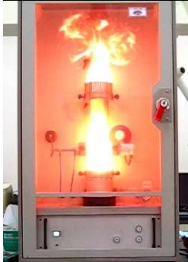
[그림 39] 뉴송분진의 최소점화에너지 측정 시 점화 장면
