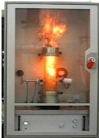
[그림 38] 함마밀분진의 최소점화에너지 측정 시 점화 장면
