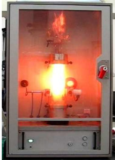
[그림 37] 사이로분진의 최소점화에너지 측정 시 점화 장면
