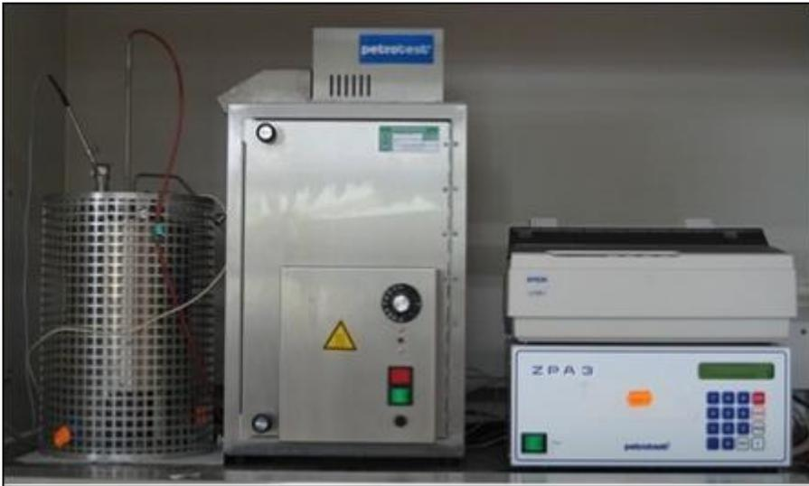
[그림 4] ZPA-3 Semiautomatic autoignition tester
